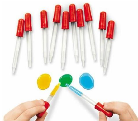
піпетки (використовують для точного вимірювання об'ємів рідини)
